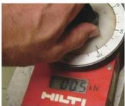
③アダプターナットを0.3～0.5kN程度まで手で締め付ける。
