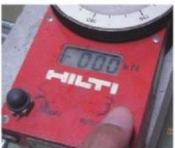
②リセットボタンを長押ししてデジタル表示を00.0kNにする。
