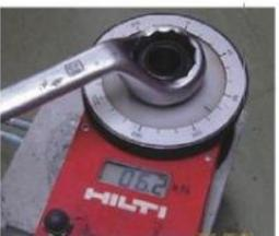
④レンチを使ってアダプターナットを所要の値(検査荷重)以上まで締め付ける。目視で最大数値を確認。(母材を押し付けることにより数値が減少していくので注意)
