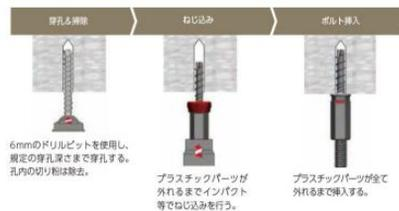
6mmのドリルビットを使用し、規定の穿孔深さまで穿孔する。孔内の粉じりは除去。
